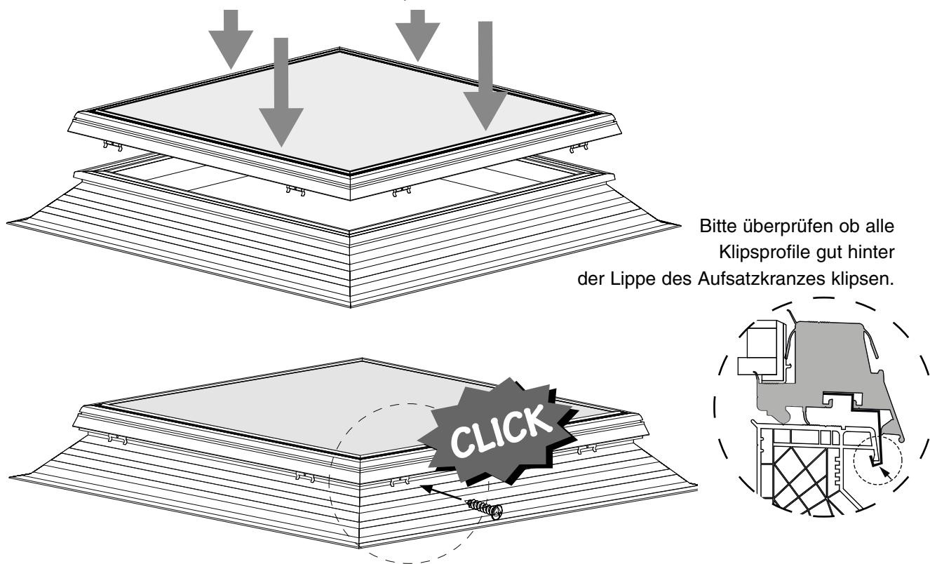
Für eine zusätzliche Verstärkung, bitte schrauben Sie die Klipsen quer durch den Aufsatzkranz mit mitgelieferten (Einweg)Schrauben.
