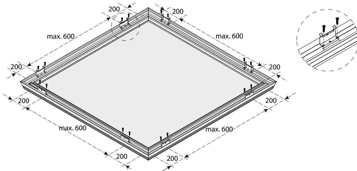
Retourner et positionner l'ensemble au dessus de la costière! Veillez à ce que les clips et l'ensemble du châssis et du vitrage, ne soient pas posés directement sur le revêtement de toiture ou sur le sous-sol (pour éviter un endommagement éventuel au revêtement de toiture ou aux clips).
