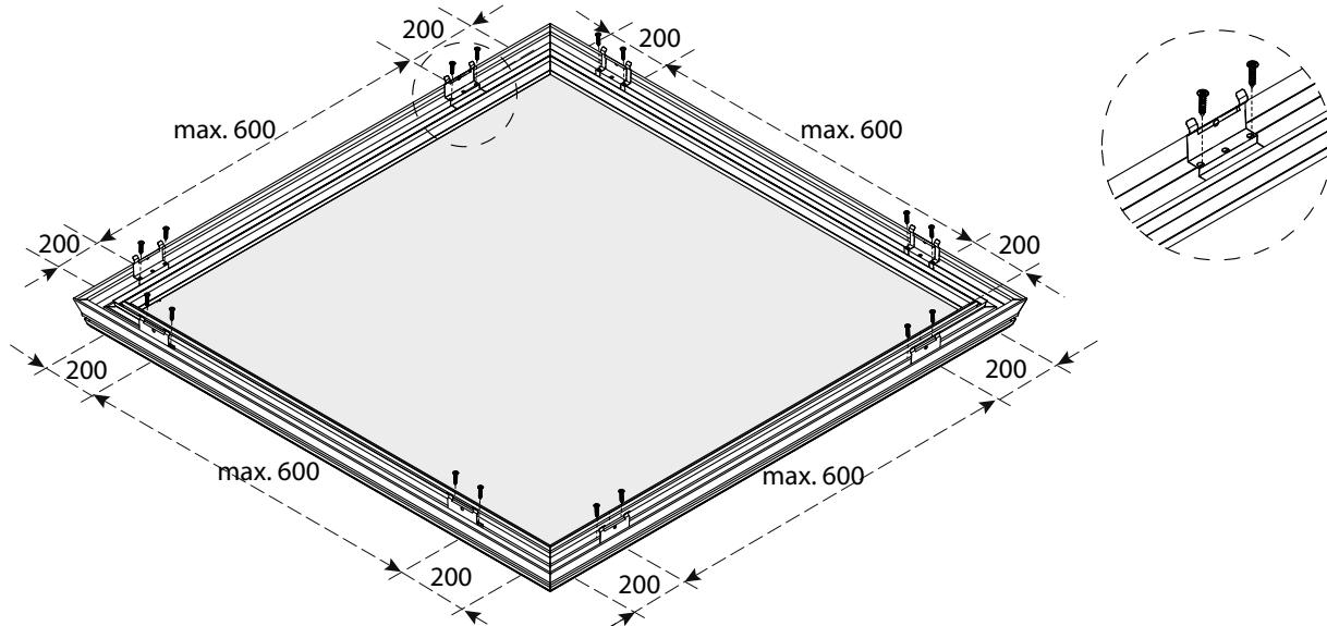
Draai het geheel om en positioneer het boven de opstand!
