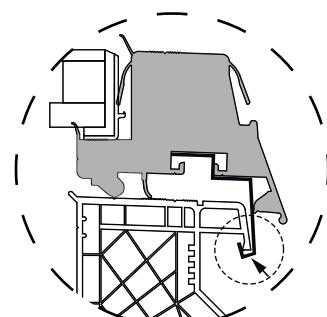
Voor extra borging schroeft u de clipsen nog vast doorheen de opstand, met de meegeleverde (one-way) schroeven.
